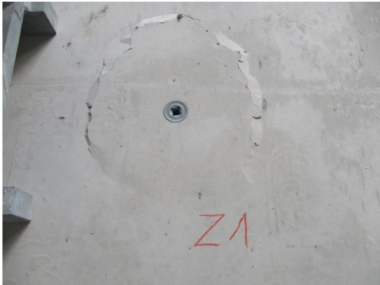
Zugversuch: Beispiel für den Betonausbruch
