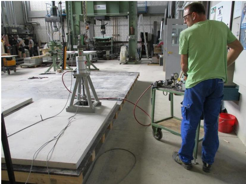
Abb. 2: Prüfvorrichtung für die Zugversuche
