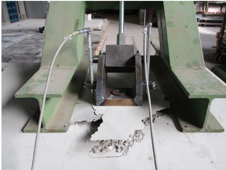
Schrägzugversuch: Versagen durch Betonausbruch
