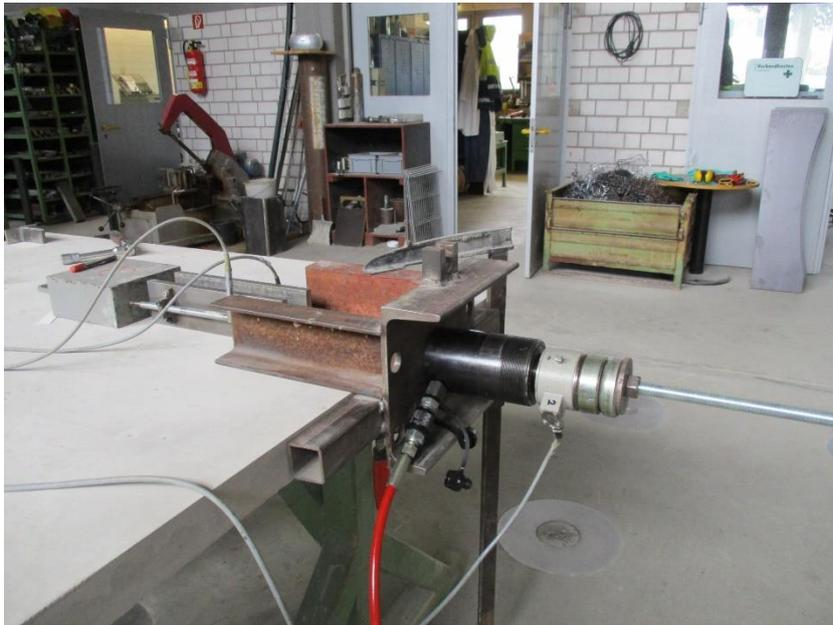
Abb. 4: Prüfvorrichtung für die Querzugversuche
