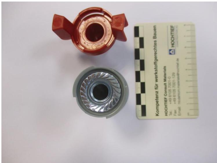
Montagedübel M12: abgeschraubte Abdeckung, innenliegende Gewindebuchse
