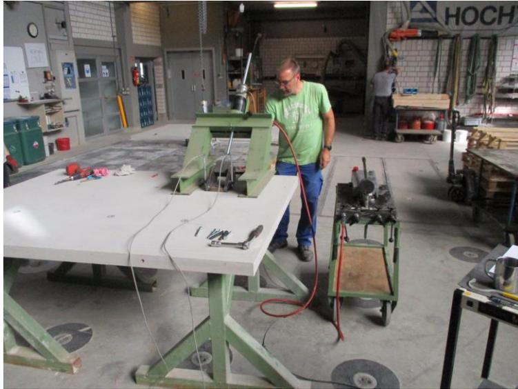
Versuchsaufbau Schrägzugversuch (unter 45°)
