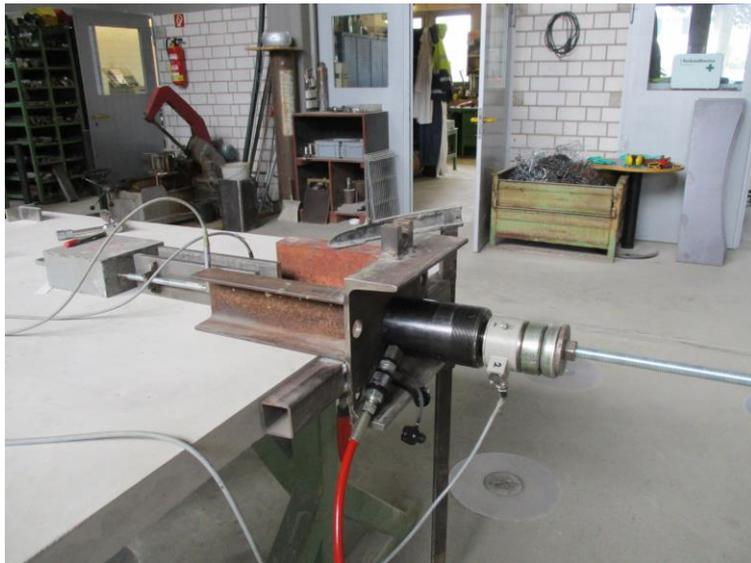
Querzugversuch: Detail zu Kraftmessdose und Wegaufnehmer
