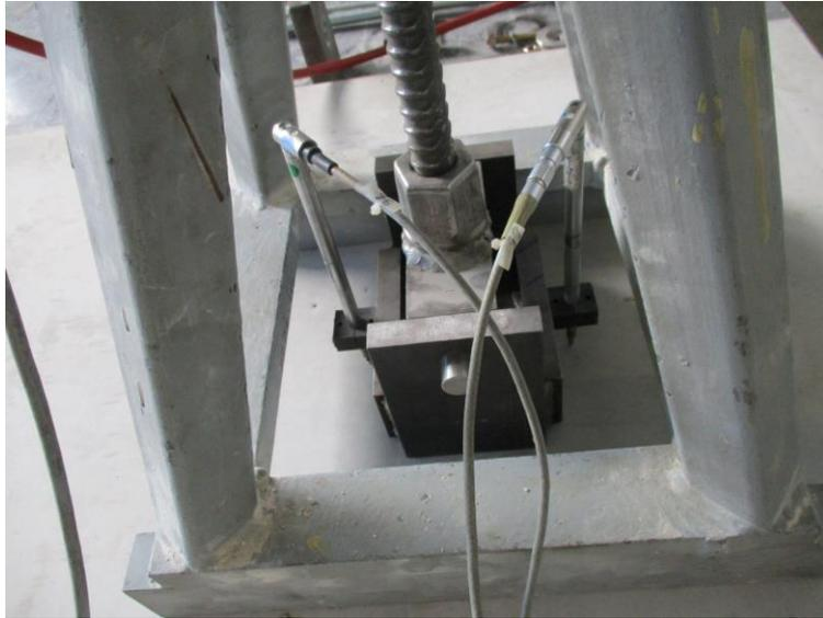
Zugversuch: Detail zu den Wegaufnehmern
