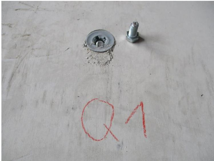
Querzugversuch: Beispiel für Stahlversagen Schraube M12 8.8
