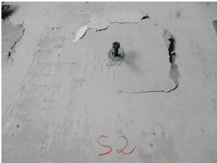
Schrägzugversuch: Beispiel für den Betonausbruch
