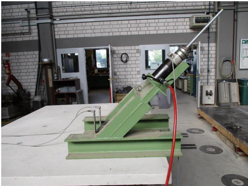
Abb. 3: Prüfvorrichtung für die Schrägzugversuche unter 45°
