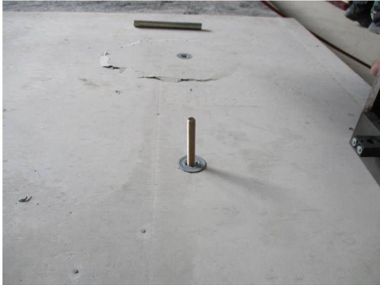
Zugversuch: Eingebaute Gewindestange M12
