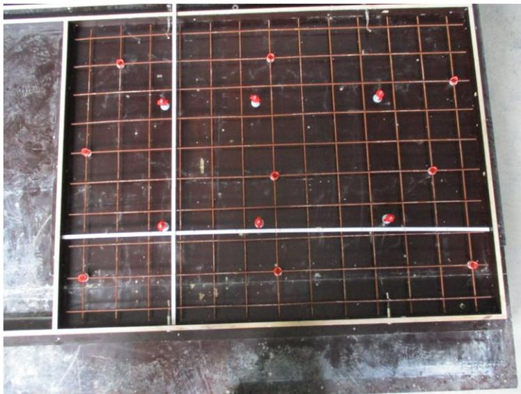
Anordnung der Montagedübel und Bewehrung bei Platte 3
