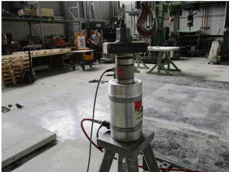
Zugversuch: Detail zur Kraftmessdose
