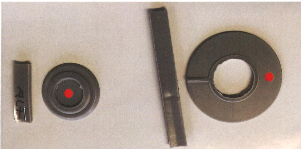
Abbildung 2: Entnommene Probekörper (links: aus Verschlussstopfen, rechts: aus Opti-Mauerstärke). Der Messbereich für die Härteprüfung ist jeweils rot markiert
