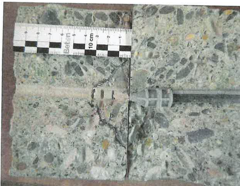
Abbildung 2 Prüfkörper 2 - Wassereindringtiefe (5 bar / 5 Tage)
