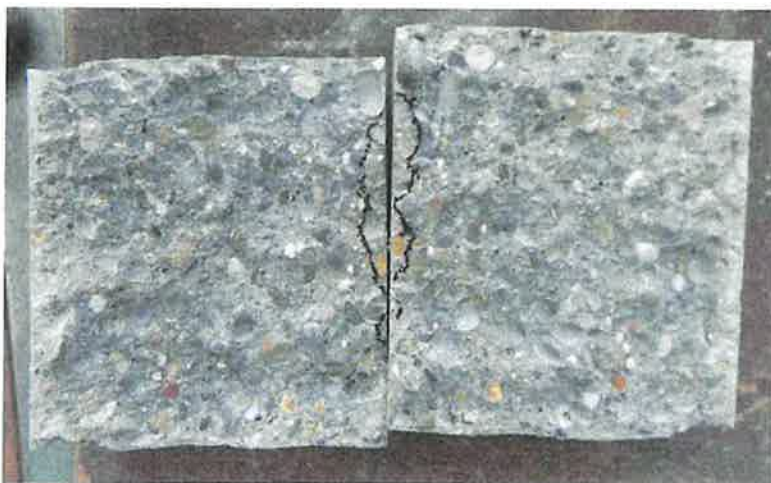
Abbildung 4: Referenzwürfel 2 nach dem Spalten
