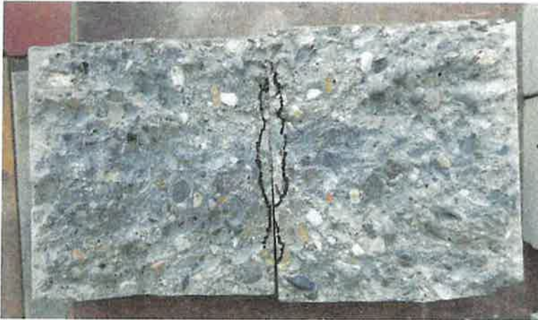
Abbildung 3: Referenzwürfel 1 nach dem Spalten
