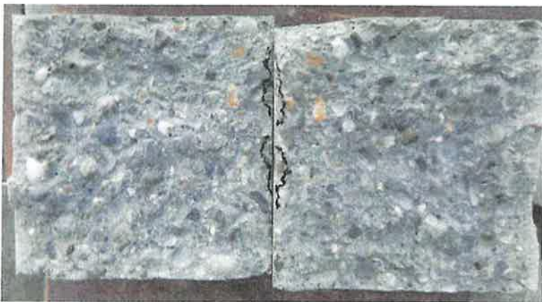
Abbildung 5: Referenzwürfel 3 nach dem Spalten
